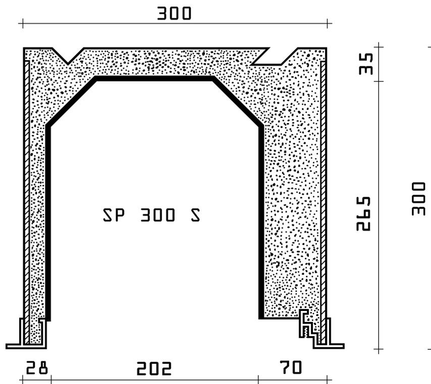
Serienmäßig haben alle Rolladenkästen der Typenreihe SP eine spezielle **Clip - Innenschiene** für den einfachen, schraublosen **EASY - CLIP - Deckelanschluss**, sowie eine Außenschiene, beide mit 15 mm Ausladung.
